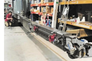
開発したロボットアーム。先端にブラシなどを取り付け、燃料デブリを回収する（資源エネルギー庁提供）
